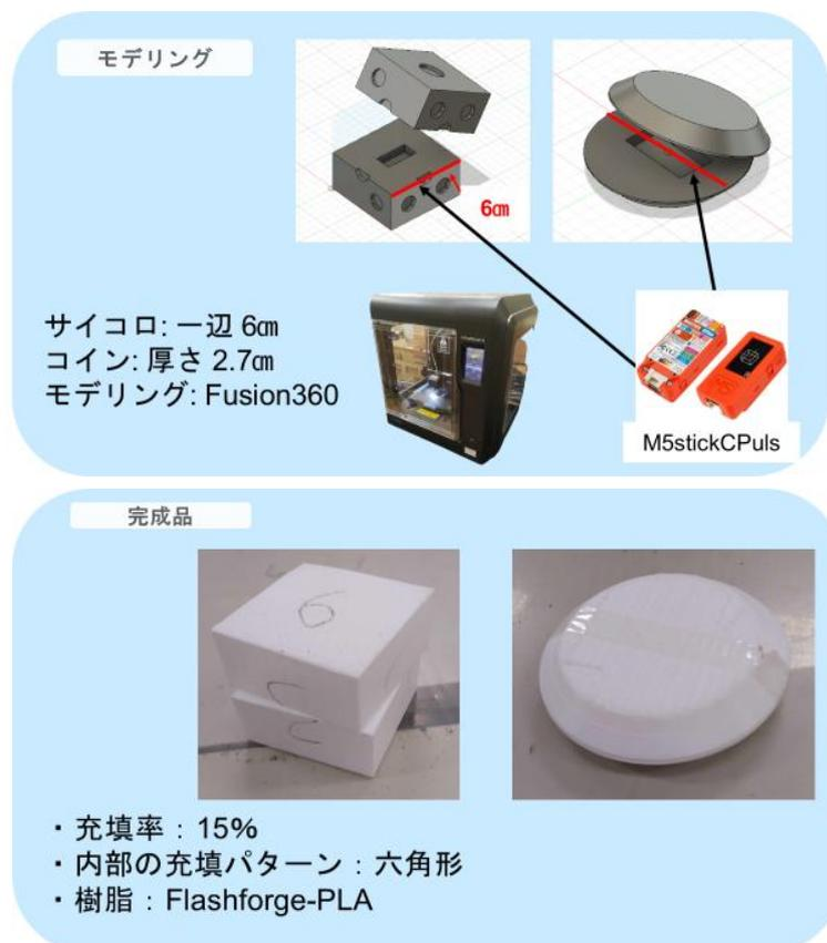
図2 モデリングと3Dプリンターによる印刷
