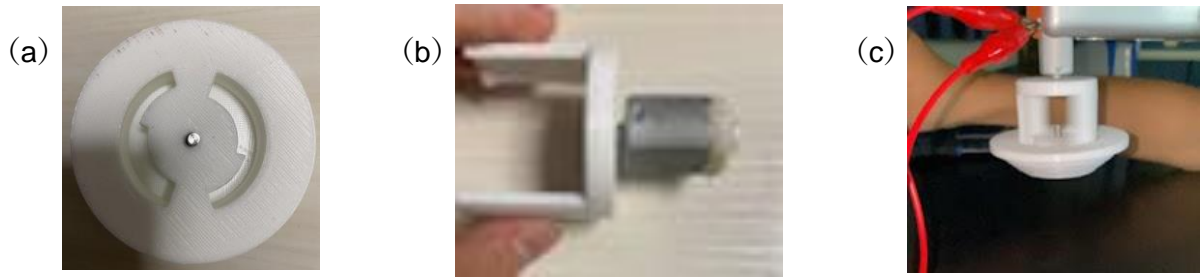
図2 射出装置をコマに取り付けた様子 (a) 自作コマ (b) 射出装置 (c) コマ+射出装置
